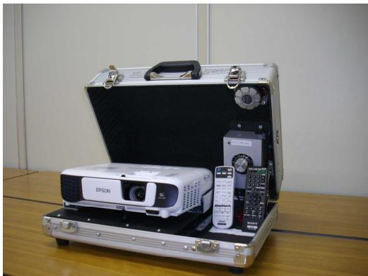
★プロジェクターとDVDプレーヤー、スピーカーが一式にセットされており、準備がいらず、簡単に映写することができます。スピーカーが付いていますので、大きな会場でも音と映像を楽しむことができます。またトランクになっているので、テレビの代わりとしても使用できます。**注意点としてパソコンと接続しても音声出力はできません。**
