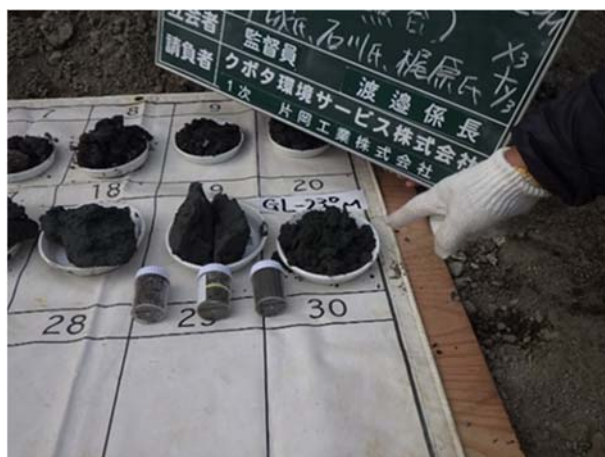
⑥地質調査の結果と照合し、支持層を確認
